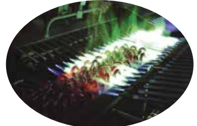
リンろう付 Copper Phosphorous Brazing
